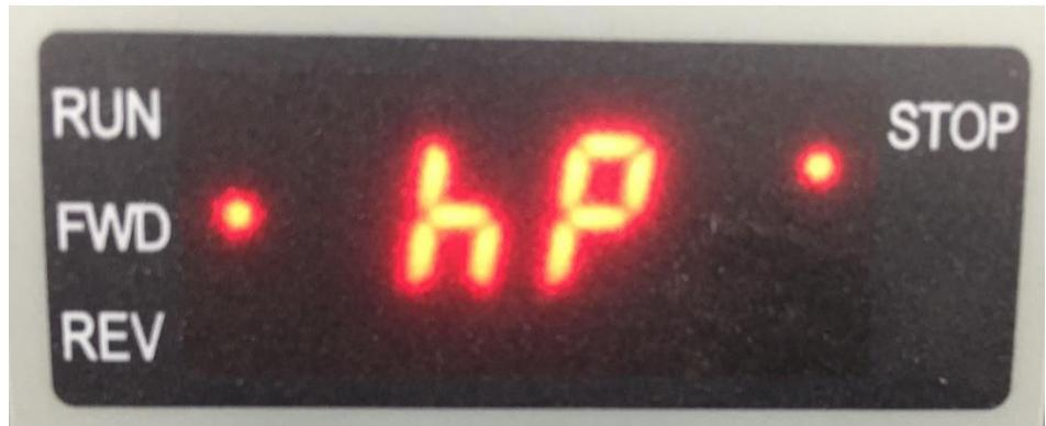
Počas PID prevádzky (riadenie na konštantný tlak) môžete šípkou (tlačidlom) hore pridávať Požadovaný nastavený tlak a naopak šípkou (tlačidlom) dole môžete znížovať hodnotu požadovaného tlaku aj počas prevádzky.
