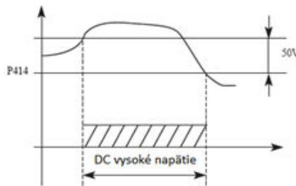
Ak je hodnota P414 príliš vysoká, jednosmerné napätie môže byť príliš vysoké a môže vyvolať zapnutie ochrany meniča. Ak je hodnota P414 príliš nízka, brzdný odpor sa môže príliš zohrievať.
