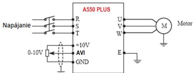
Vysvetlenie: riadiaca výstupná frekvencia meniča sa ovláda pomocou AVI napäťového signálu z externého POT (napr. 10 kΩ). Poloha J2 = V
