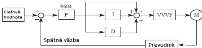
Nastavte hornú hraničnú hodnotu. Ak hodnota spätnej väzby prekročí nastavenú hodnotu, spustí sa poplach. Maximálny vstup (20 mA / 10 V) nameranej hodnoty (svorka AV1) zodpovedá 100%.
