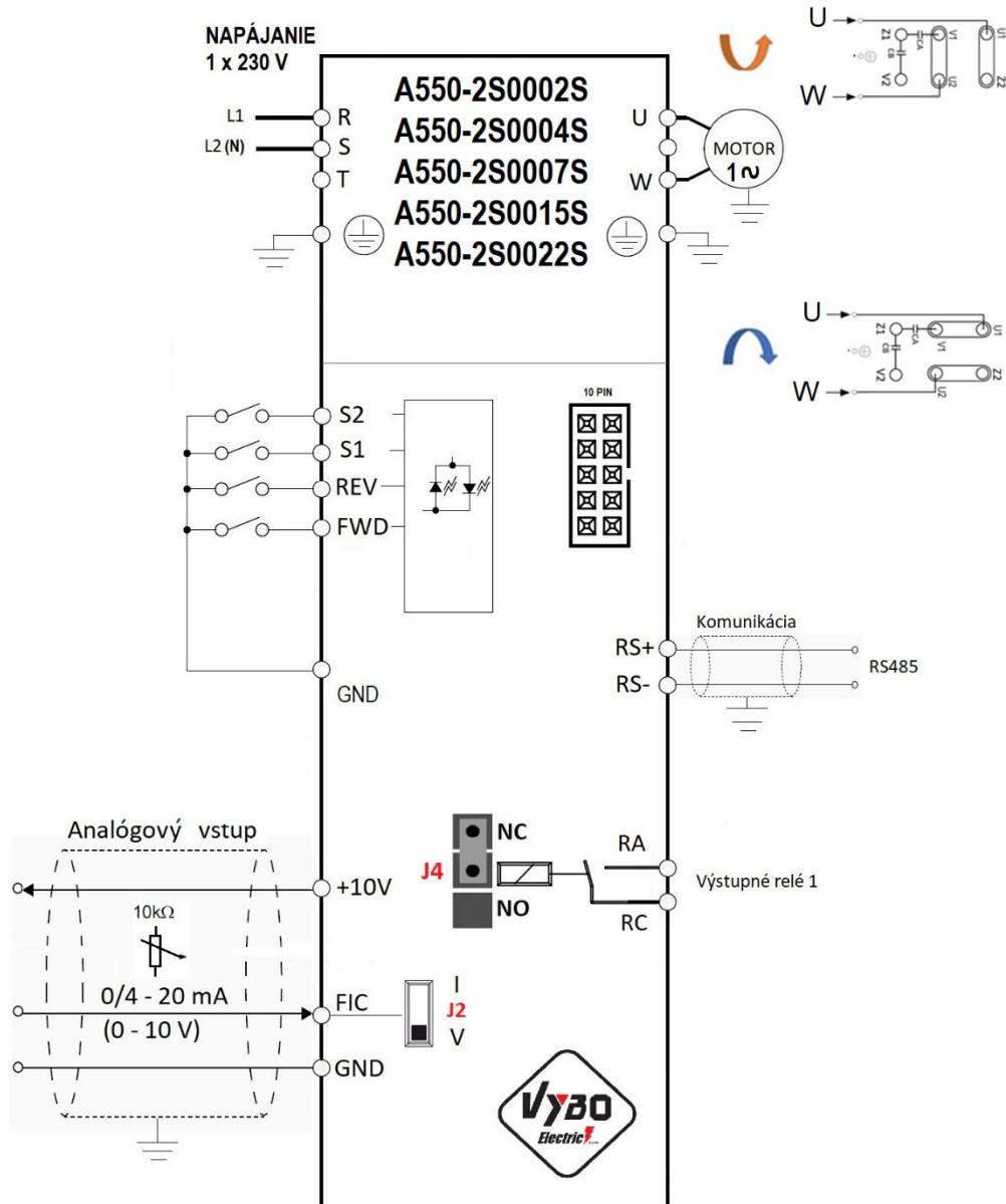
\*Zapojenie platí len pre typy 1 fázových elektromotorov vhodné na takéto zapojenie, pre tento druh riadenia, odporučené výrobcom elektromotora.
