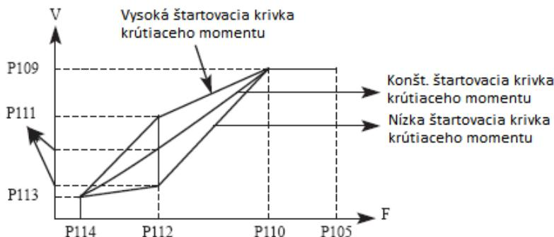
P109: Maximálne napätie V/F sa nastavuje podľa pripojeného motora. Všeobecne sa nastaví na menovité napätie motora. Keď sa motor nachádza v blízkosti meniča, zvyčajne do 30 metrov, mal by byť nastavený na vyšiu hodnotu.
